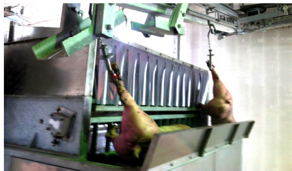
Brühbottich mit autom. Entfesselung
