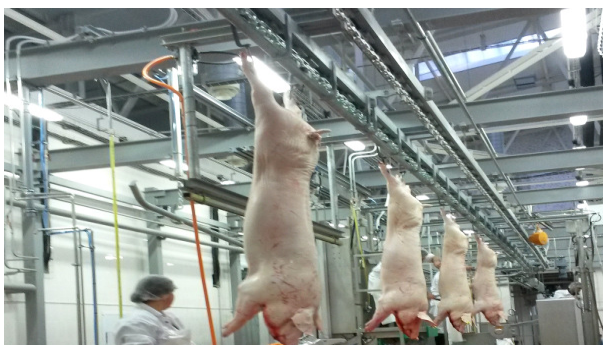
Ausschlachtlinie mit autom. Förderanlage (Schwein)
