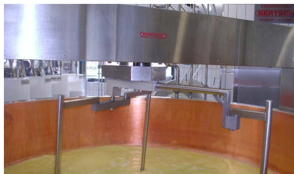
Das Planetenrührwerk ist die ideale Ausrüstung für Käsekessel über 2500 l Nutzinhalt
