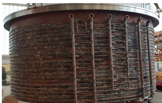
Innenkessel mit aufgelöteten Heizschlangen für Heisswasserbetrieb
