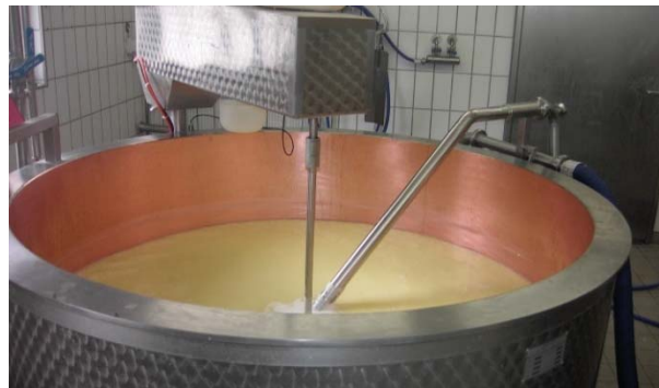
Das Entleeren der Käsekessel erfolgt entweder über ein Absaugrohr oder ein von uns angepasstes Bodenventil
