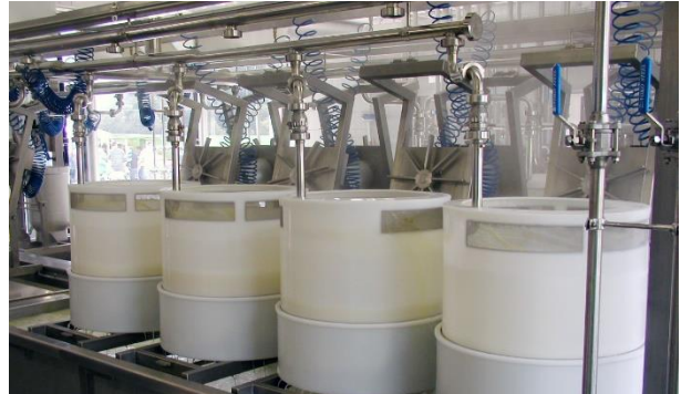
Abfüllanlage mit Klapppressen
