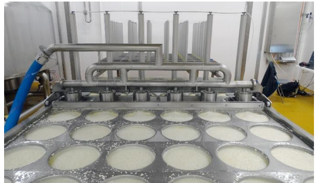
Automatische Direktabfüllung in die Käseformen
