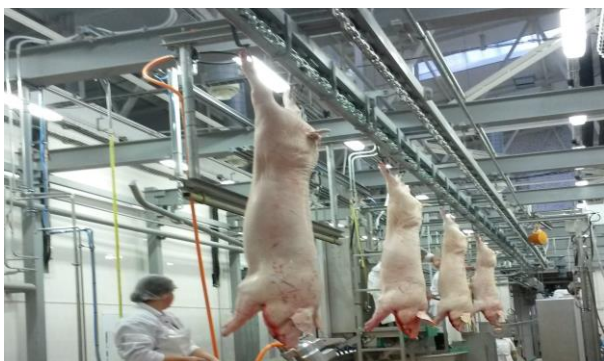
Ausschlachtlinie mit autom. Förderanlage (Schwein)
