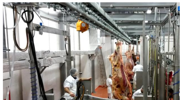
Ausschlachtlinie mit autom. Förderanlagen (Rind)
