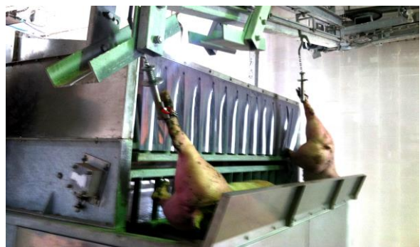
Brühbottich mit autom. Entfesselung
