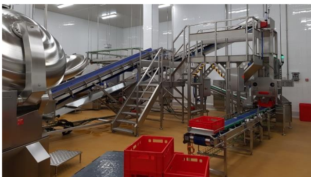
Transportförderband und automatische Kistenabfüllstation
