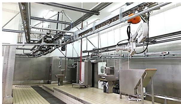
Линия разделки и нутровки туш
