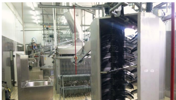
Установка вторичной зачистки
