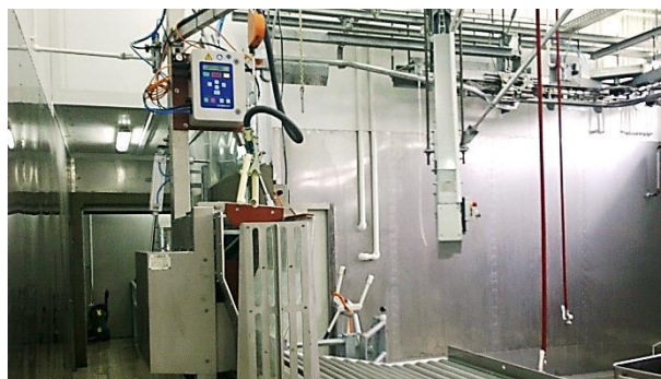
Оглушение электрическим током
